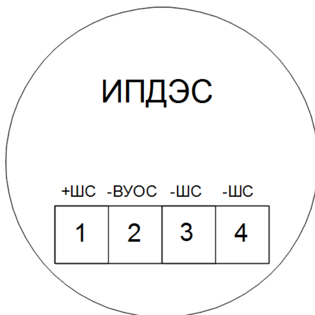
Рис. 8.1. Схема разметки места установки извещателя.
